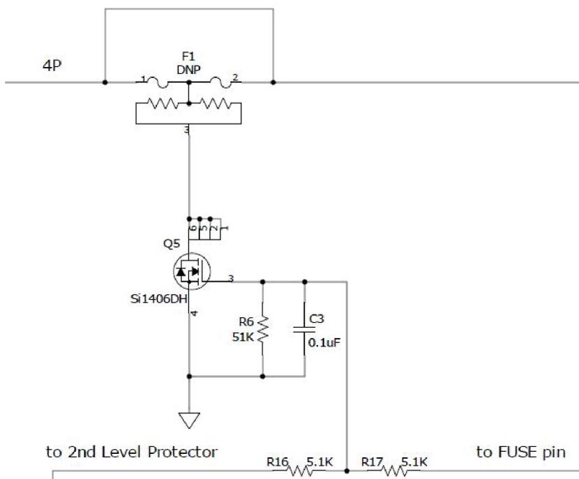
图 31. FUSE Circuit
