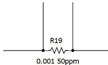
图 25. Sense Resistor
