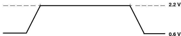
Figure 3. TTL-Level Inputs
