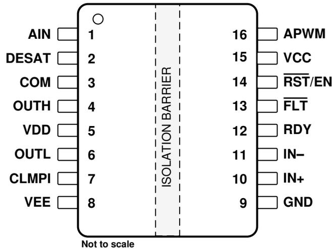
图 5-1. UCC21750 DW SOIC (16) Top View
