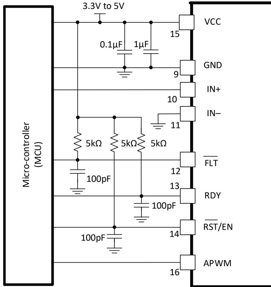
图 9-3.  $\overline{\text{FLT}}$ ,  $\text{RDY}$ , and  $\overline{\text{RST/EN}}$  Pins Circuitry
