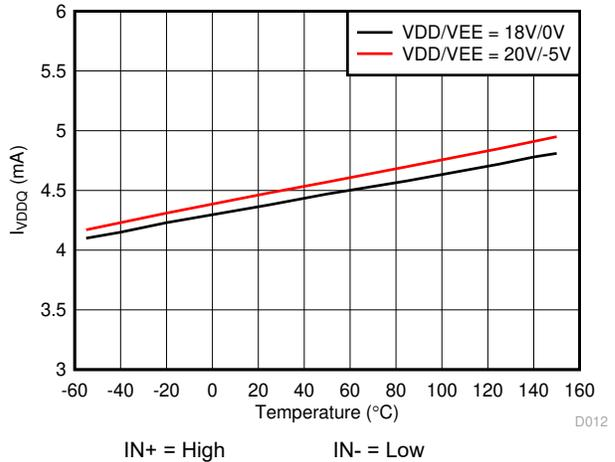
图 6-9. I<sub>VDDQ</sub> Supply Current vs Temperature
