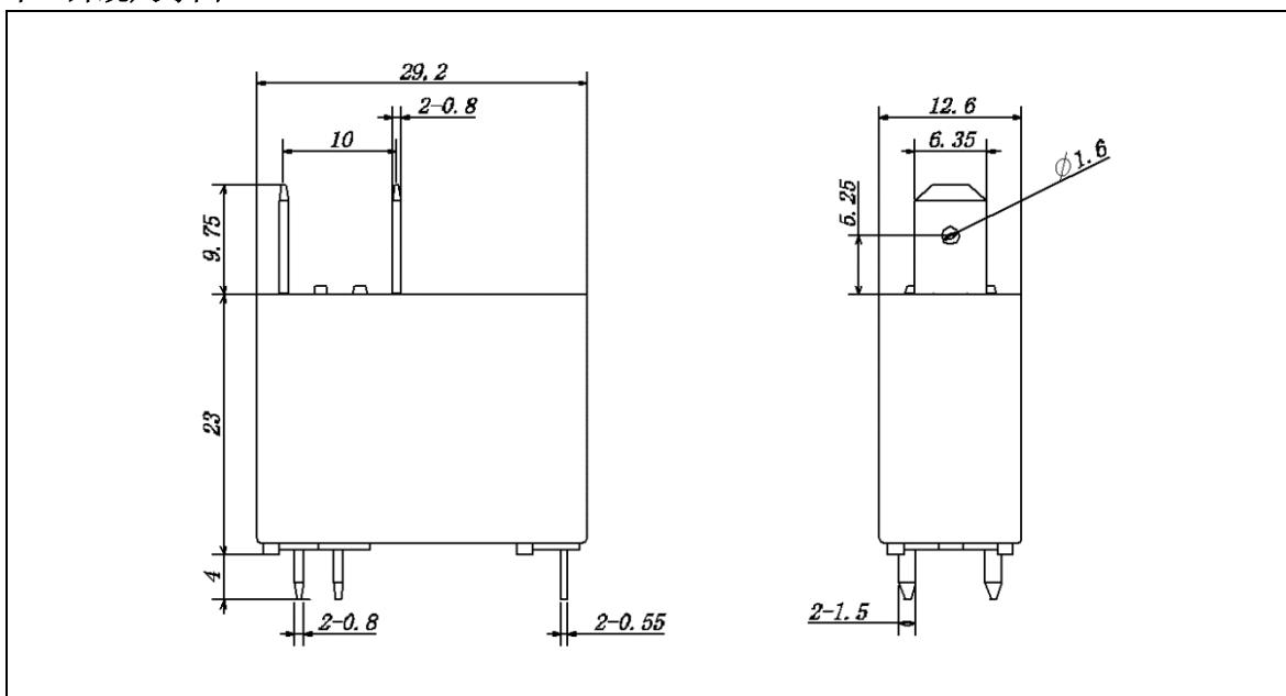
备注：外形图中产品部分未注公差尺寸，当尺寸 $\leq 1\text{mm}$ ，公差为 $\pm 0.2\text{mm}$ ；
