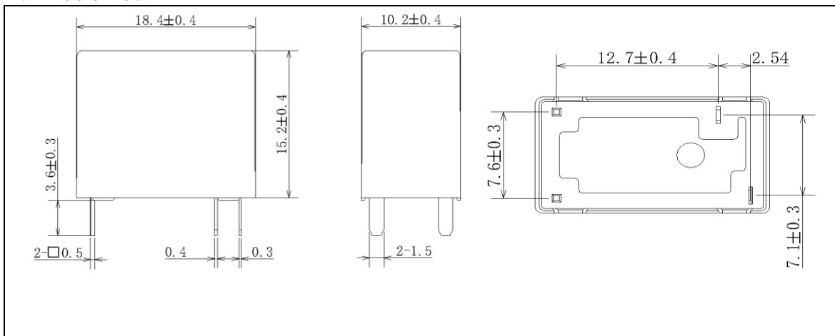
备注：外形图中产品部分未注公差尺寸，当尺寸 $\leq 1\text{mm}$ ，公差为 $\pm 0.2\text{mm}$ ；
