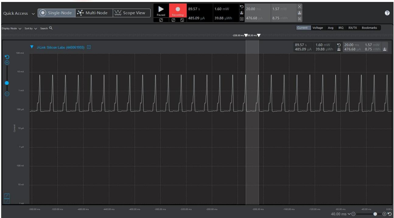
(2) 打开 EN 内部上拉, 100 ms 连接间隔
