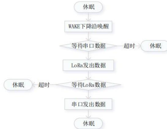
图 10 LSR 工作流程
