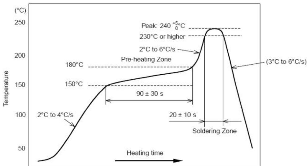
图 5. 部件的焊接耐热性温度曲线(焊接点)
