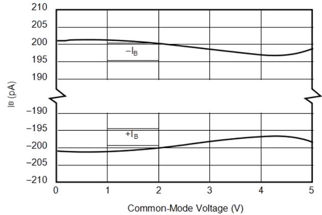
Figure 6. 输入偏置电流与共模电压间的关系
