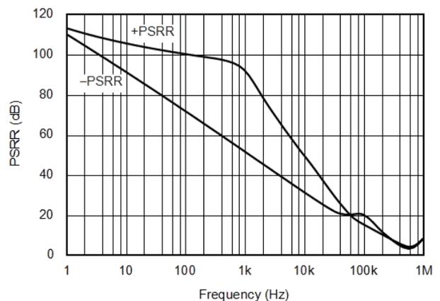
Figure 4. 电源抑制比与频率间的关系
