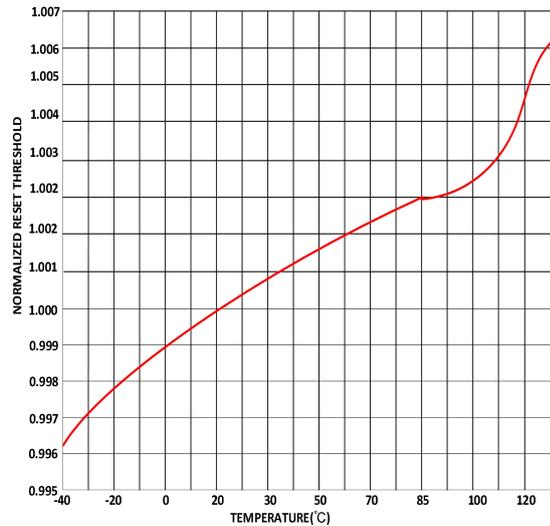
图 4. 复位阈值偏差 vs 温度
