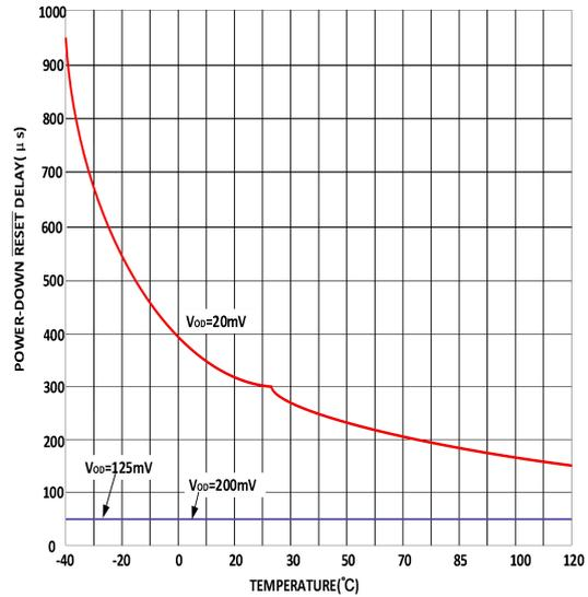
图 2.下电复位延时 vs 温度
