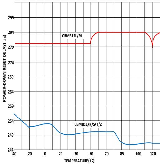
图 3.上电复位超时 vs 温度
