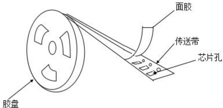
※ 塑胶带尺寸结构(适合 ‘AM05、AM06、AM10、AM08、AM12、AM20’ 型产品)
