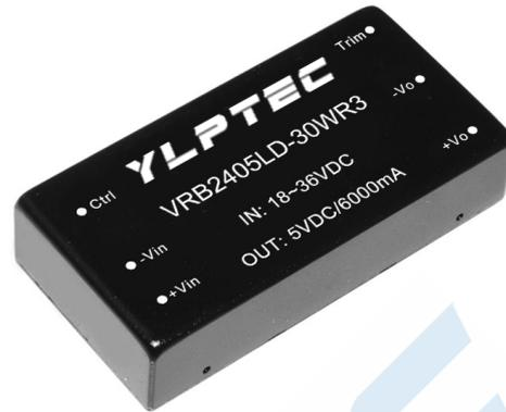
应用范围: VRB\_LD-30WR3 系列产品输出功率为30W, 2:1 宽电压输入范围, 效率高达90%, 1500VDC 的常规隔离电压, 允许工作温度范围-40°Cto +80°C, 具有输出短路、过压、过流保护功能, 广泛应用于数据传输设备、电池驱动设备、通讯设备、分布式电源系统、混合模/数系统、远程控制系统、工业机器人系统等领域。
