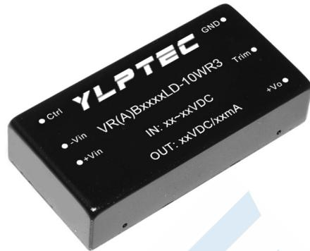
应用范围: VR(A)B\_LD-10WR3 系列产品输出功率为10W,2:1宽电压输入范围,效率高达91%,1500VDC的常规隔离电压,允许工作温度-40°C to +85°C, 具有输入欠压保护, 输出过压、过流、短路保护功能, 裸机满足CISPR32/EN55032 CLASSA,广泛应用于医疗、工控、电力、仪器仪表、通信、铁路等领域。
