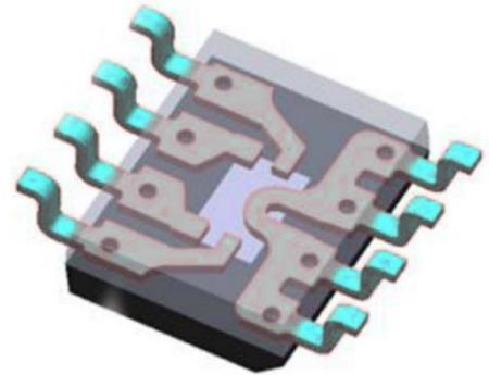
线性霍尔电路采用先进的 BCDMOS 制程生产，其中包含了高灵敏度霍尔传感器、霍尔信号预放大器、高精度霍尔温度补偿单元、振荡器、动态失调消除电路和放大器输出模块。在无磁场的情况下，电流传感器静态输出为 2.5V 固定电压或 50%VCC。在电源电压 5V 条件下，传感器静态输出可以在 0.2~4.8V 之间随磁场线性变化，线性度可达 0.4%。
