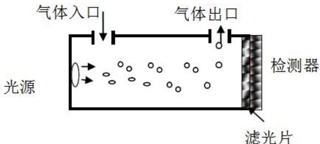
基本数学模型如下：大部分有机和无机多原子分子气体在红外区有特定吸收波长。当红外光通过时，这些气体分子对特定波长的透过光强可由朗伯-比尔定律表示： $I = I_0 e^{-kp1}$ ，吸收光强  $i$  可表示为： $i = I_0 - I = I_0 (1 - e^{-kp1})$ 。式中， $I_0$  为入射光强； $I$  为透过光强； $I$  为气体介质厚度， $p$  为气体浓度， $k$  为吸收系数。
