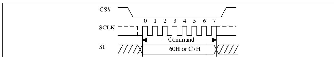
Figure 10-32a Chip Erase (CE) Sequence (QPI)
