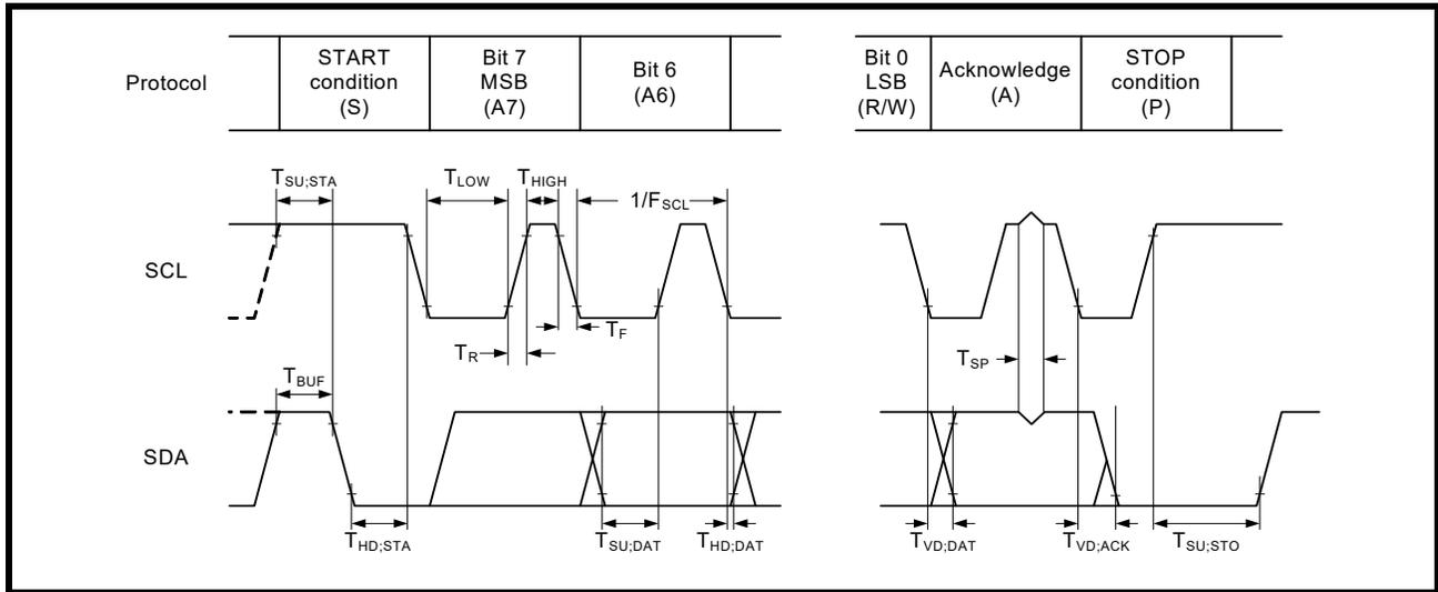
**FIGURE 7. WRITE TO OUTPUT**
