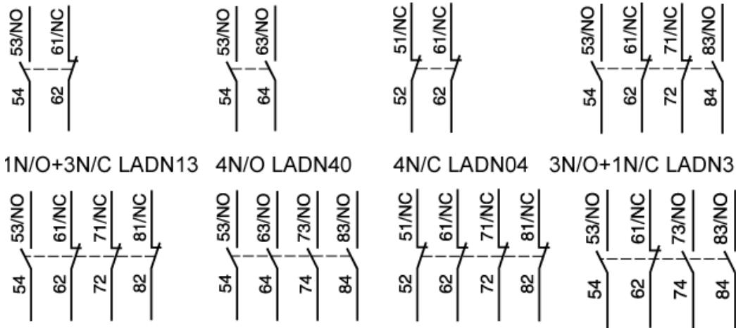
侧装辅助触点模块 (瞬时辅助触点)
