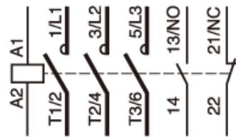
正装辅助触点模块 (瞬时辅助触点)
