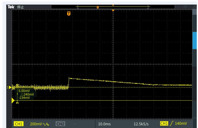
V_{in}=90\text{V} , 满载 1.5A 切换到空载, \Delta V=172\text{mV}
