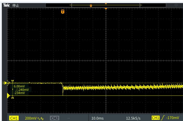
V_{in}=90\text{V} , 空载切换到满载 1.5A, \Delta V=240\text{mV}
