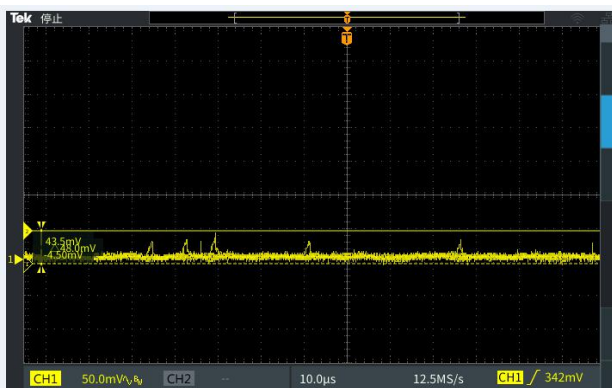
12V 空载 V_{pp}=55mV
