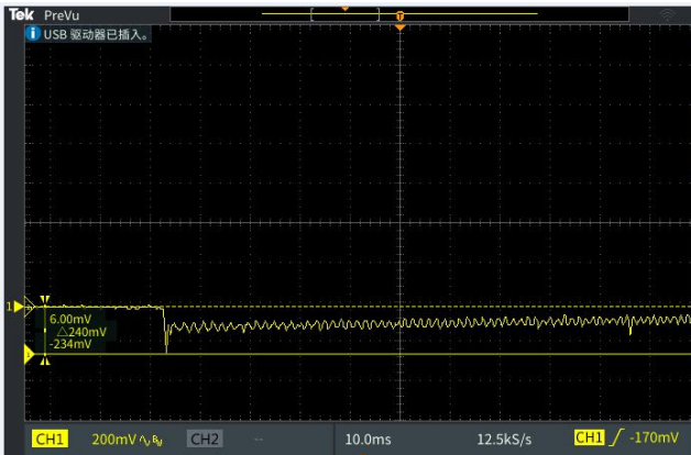
V_{in}=12\text{V} , 空载切换到满载 1.5A, \Delta V=240\text{mV}
