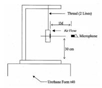
1 METER FROM MICROPHONE TO FAN INTAKE
