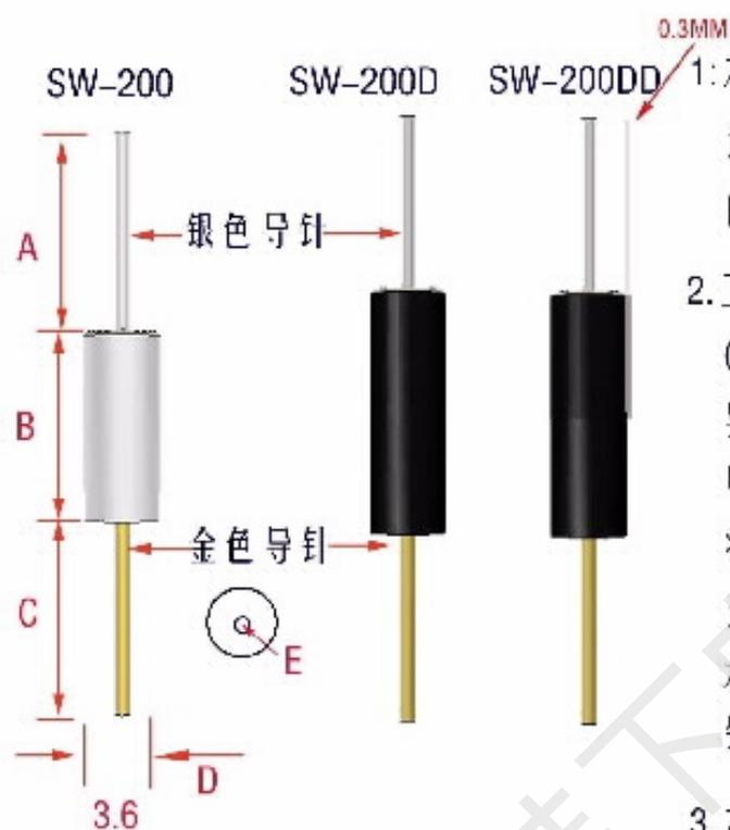
1. 本开关使用金属材质制造, 电气特性与水银开关近似但没有水银开关的危险性及环保问题, 晃动时有单向导通之特性, 装配使用更为方便安全.
