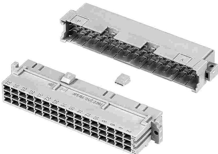
按照图纸所示将码键插入母连接器其中一个键槽中。扳掉公套的相应部位。支架间距在 20.32 mm 以上时才能使用采用这种编码方法的连接器。
