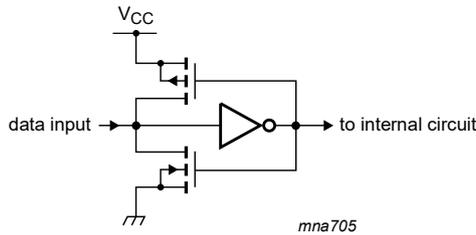
Fig. 4. Bus hold circuit
