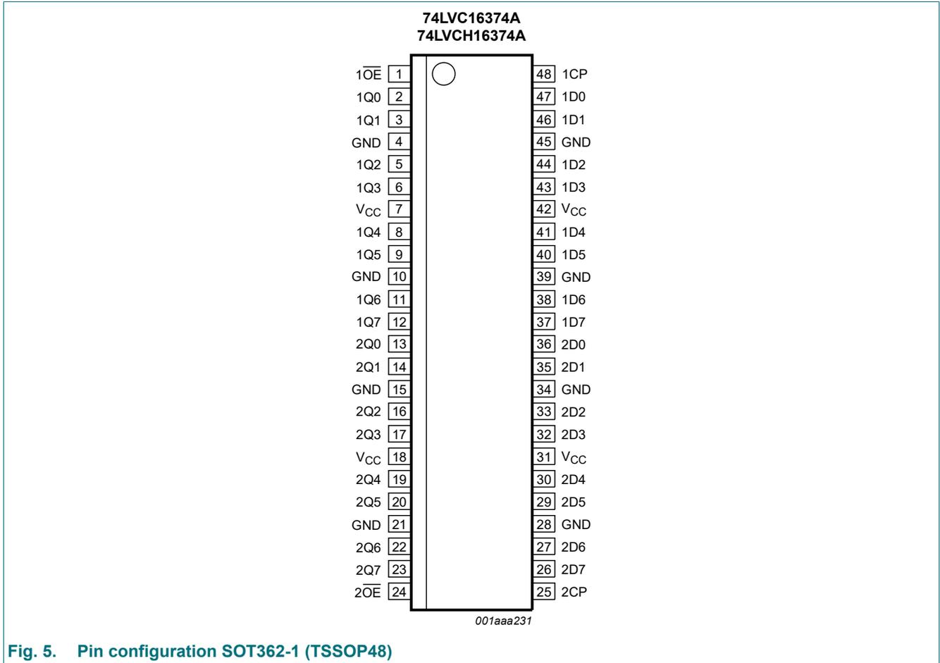
Fig. 5. Pin configuration SOT362-1 (TSSOP48)
