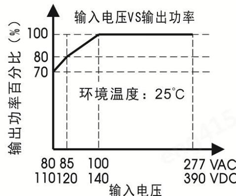
注：1.对于输入电压为 80 - 100VAC/110 - 140VDC 需在温度降额的基础上进行输入电压降额；
