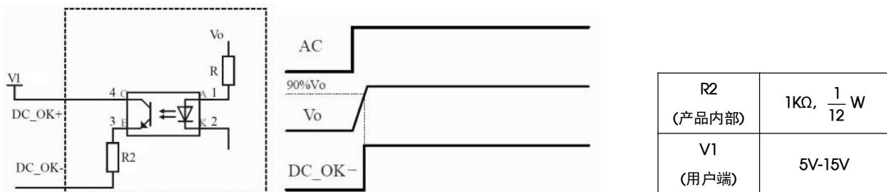
注：1.产品输出电压建立至90%额定值时，DC\_OK+与DC\_OK-连通；
