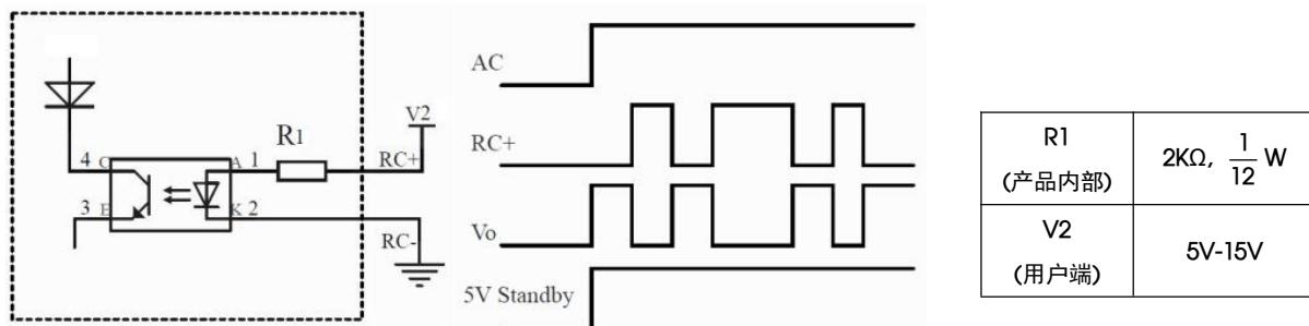
注：1.产品正常工作时，在RC+，RC-施加一定电压，触发远程关断功能，输出电压关闭，撤销该电压，输出电压重新建立；
