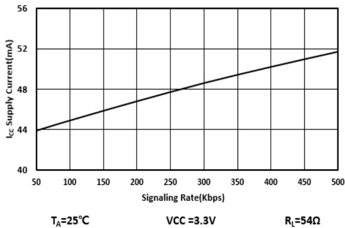
图 7-12. 电源电流与数据速率
