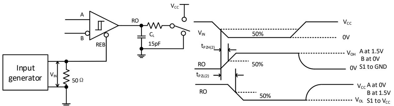
图 8-8 接收器使能/禁止时间，驱动器禁止
