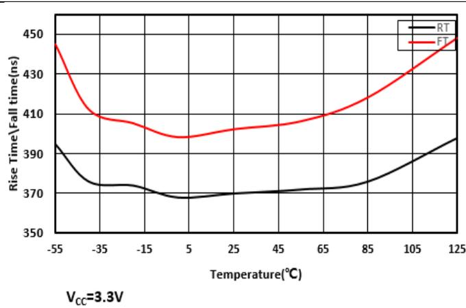
图 7-10. 驱动器输出上升/下降时间与温度
