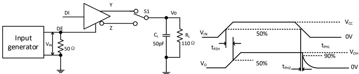
图 8-4. 驱动器使能和禁用时间：高电平输出，带下拉负载
