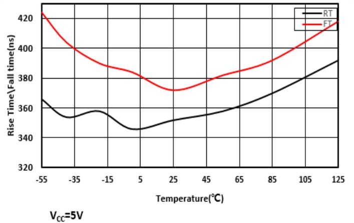
图 7-13. 驱动器输出上升/下降时间与温度
