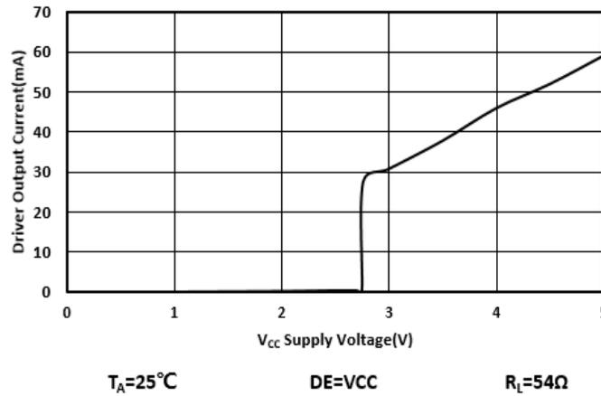
图 7-9. 驱动器输出电流与电源电压
