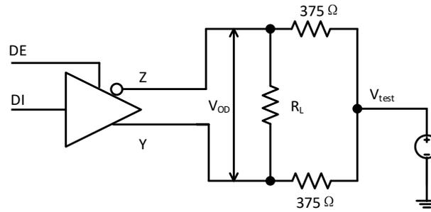
图 8-1. 驱动器差分输出电压 @ 共模负载
