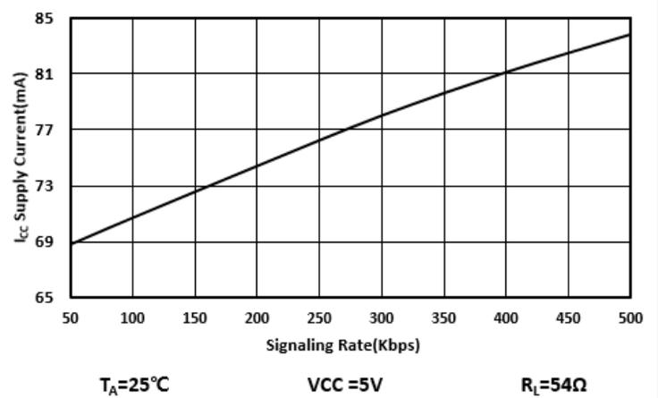
图 7-15. 电源电流与数据速率
