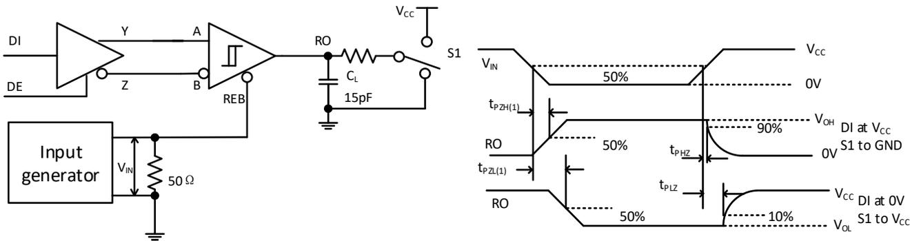
图 8-7. 接收器使能/禁止时间，驱动器使能
