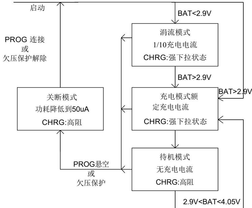
图 5：一个典型充电循环的状态图
