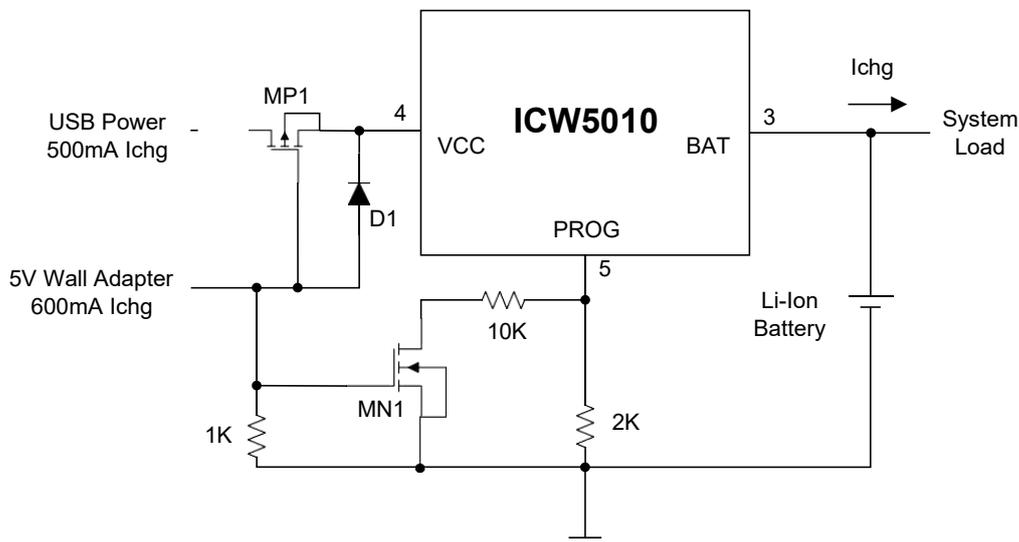
图10: 交流适配器与USB电源的组合
