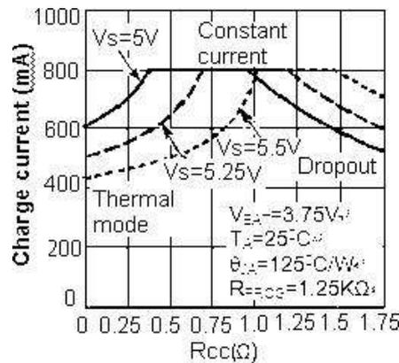
图 9: 充电电流与Rcc的关系曲线
