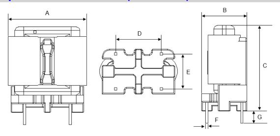
PCB aperture ≥ Ф 1.4mm
