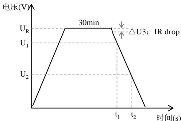
容量计算公式：  $C = \frac{I \times (t_2 - t_1)}{U_1 - U_2}$
