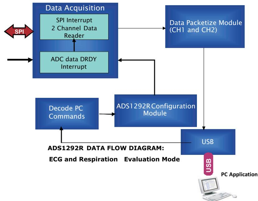
**Figure 36. Evaluation Mode Data Flow for ADS1292R**
