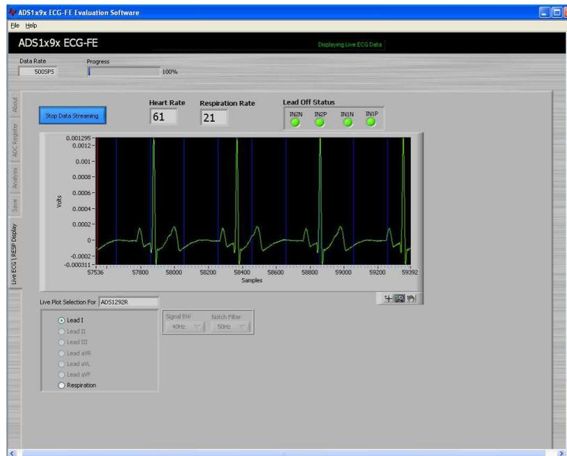
Figure 31. PC Application Live ECG for ADS1292R
