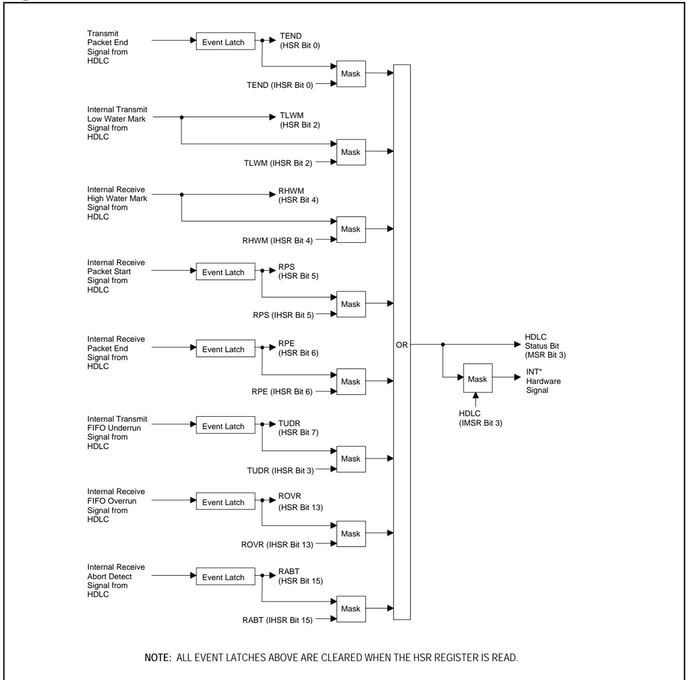
**Figure 4-6. T2E2SR1 Status Bit Flow**
