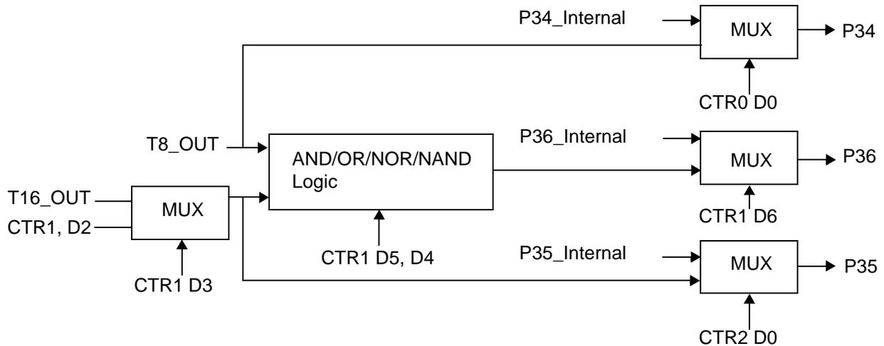
**Figure 26. Output Circuit**
