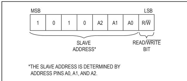
Figure 2. DS4550 I<sup>2</sup>C Slave Address Byte
