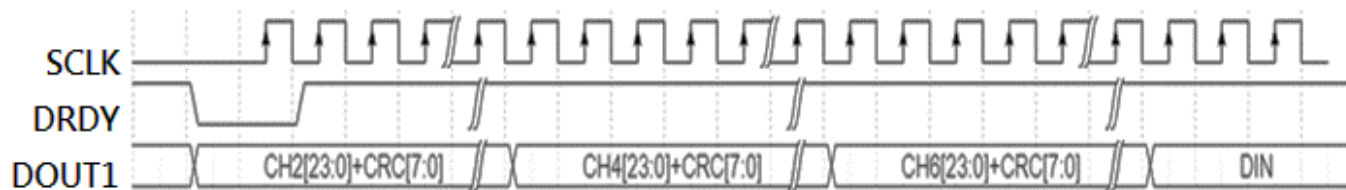
Figure4-5 SPI 单信道动态模式 ( CRC_EN=1，使能ADC2/4/6 )
