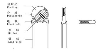
包封层(Coating) : 环氧树脂(Epoxy Resin)
