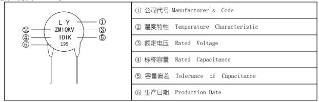
说明:生产日期第一位表示制作年度,标示方法参照年度对照表;第二位表示制作月份,第三位表示具体制作日期,标示方法参照 34 进制对比表;例如:生产日期 195 表示: 1:2021 年 9:9 月, 5:5 日
