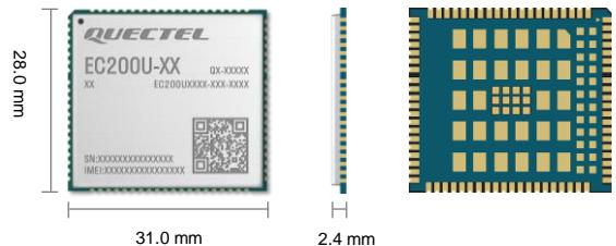
EC200U 系列是移远通信最新推出的 LTE Cat 1 无线通信模块，支持最大下行速率 10 Mbps 和最大上行速率 5 Mbps，具有超高性价比；同时在封装上兼容移远通信多网络制式 LTE Standard EC20-CE、EC20-CN、EC200S 系列、EC21 系列、EG21-G、EC25 系列和 EG25-G 模块，实现了兼容模块之间的切换。EC200U 系列还支持标准的 Mini PCIe 封装，以满足不同行业产品应用需求。
