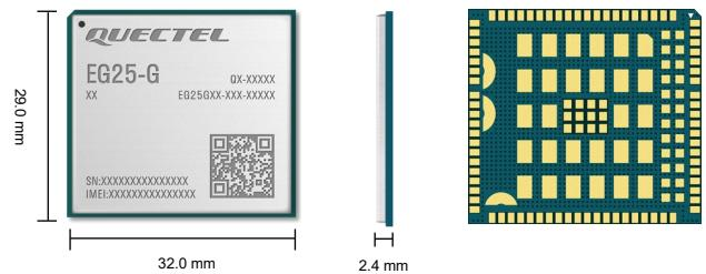
EG25-G 是移远通信专为 M2M 和 IoT 领域而设计的 LTE Cat 4 无线通信模块，采用 3GPP Rel.11 LTE 技术，支持最大下行速率 150 Mbps 和最大上行速率 50 Mbps。同时，EG25-G 在封装上兼容移远通信 UMTS/HSPA+ UC200T 系列模块、多模 LTE Standard EC2x 系列（EC25 系列、EC21 系列和 EC20-CE）/EC200A 系列/EG21-G 模块，在设计和使用中可以灵活切换。
