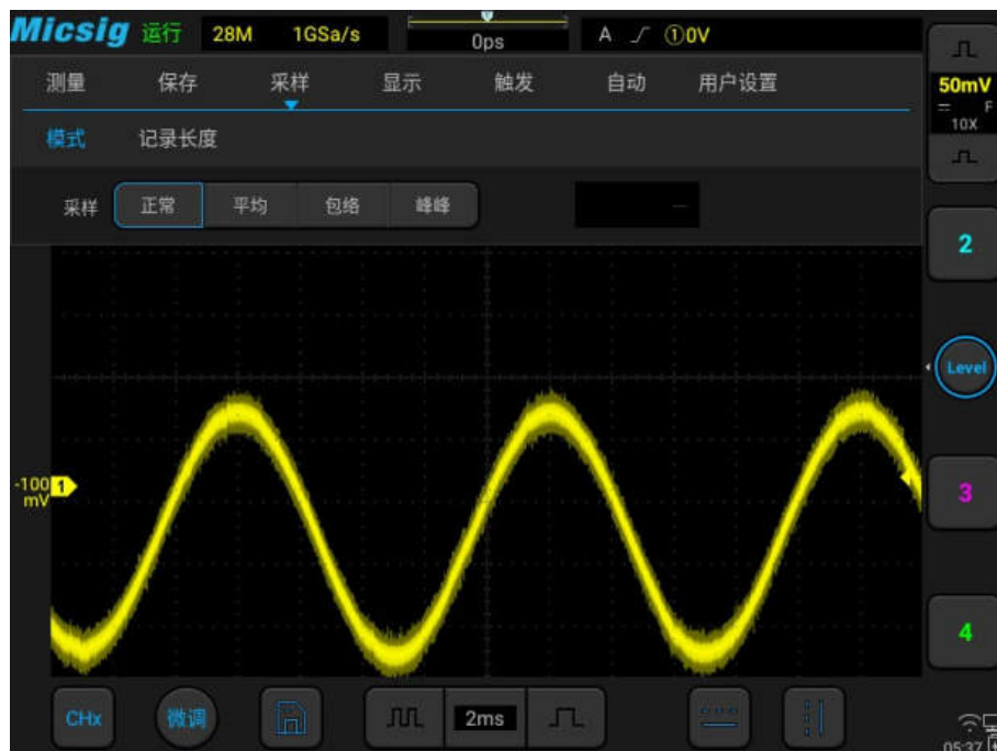
图11-5 带毛刺的正弦波，正常采样模式
