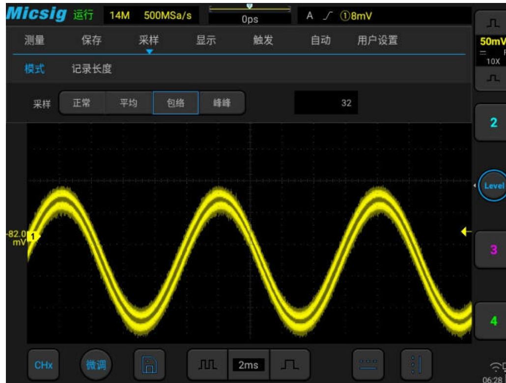
图11-8 包络采样模式（32）下的调幅信号
