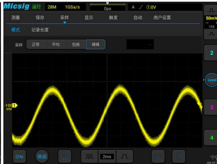
图11-6 带毛刺的正弦波，峰值采样模式
