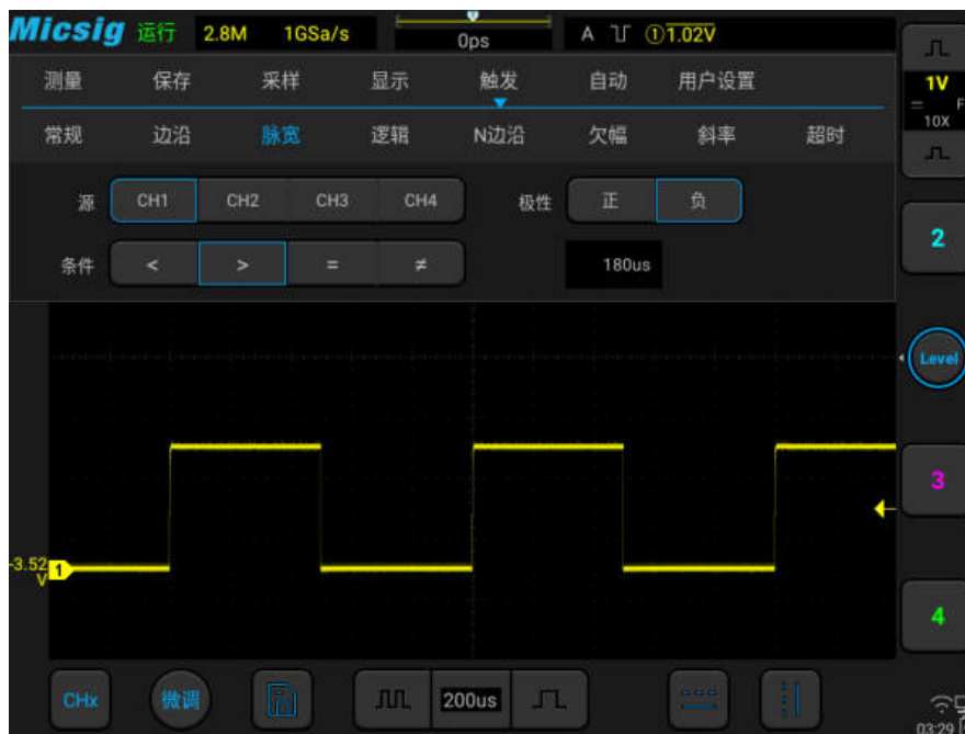
图6-15 负极性脉冲电平翻转
