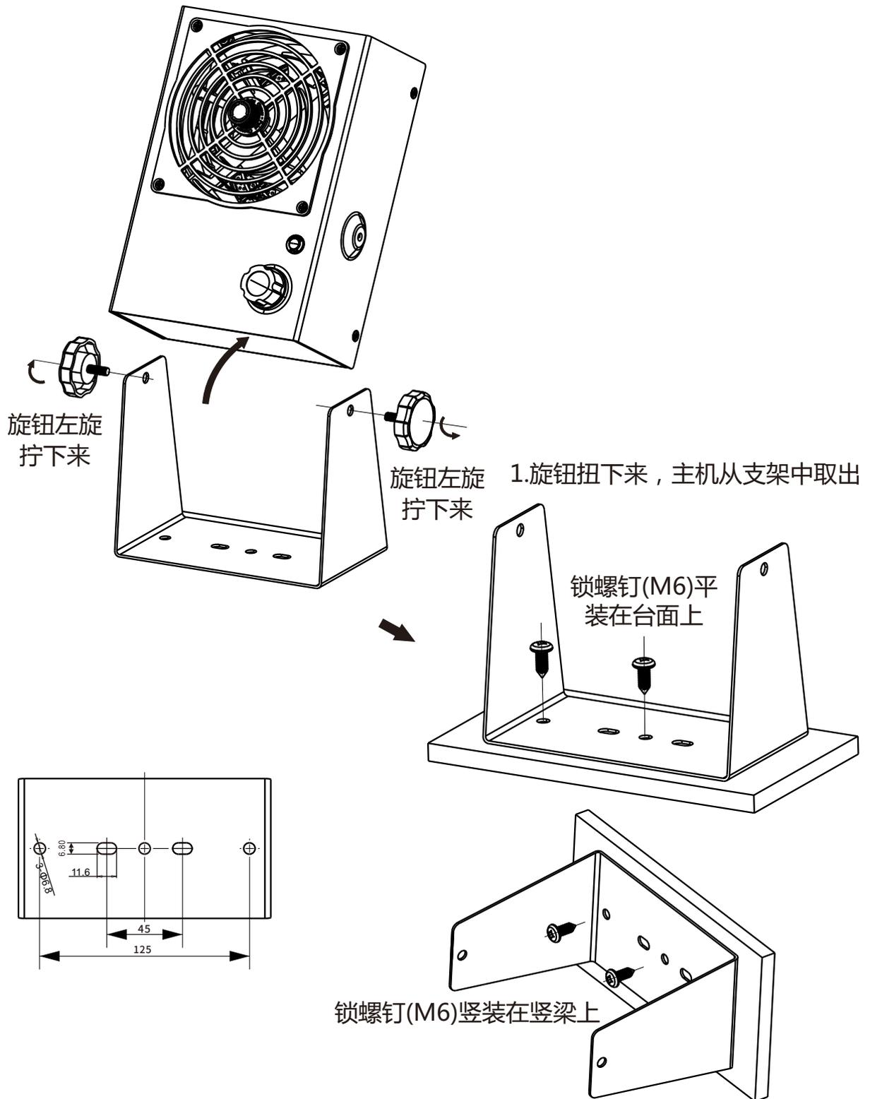
2. 將安裝支架鎖螺釘固定在安裝架上（根據使用環境調整安裝）
