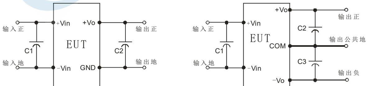
2、纹波&噪声测试：（双绞线法 20MHZ 带宽）
