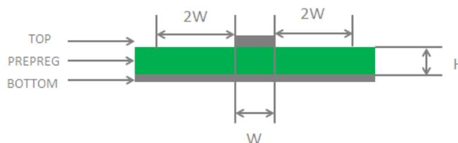
图 12：两层 PCB 板微带线结构
