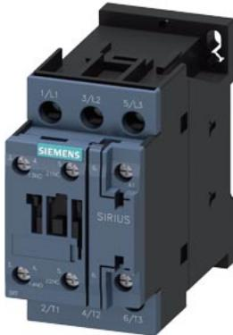
接触器 48 V AC 50/60 Hz AC3 15 kW 400 V 辅助触点 1 个常开触点 + 1 个常闭触点 3 极, 规格 S0 螺丝端子
