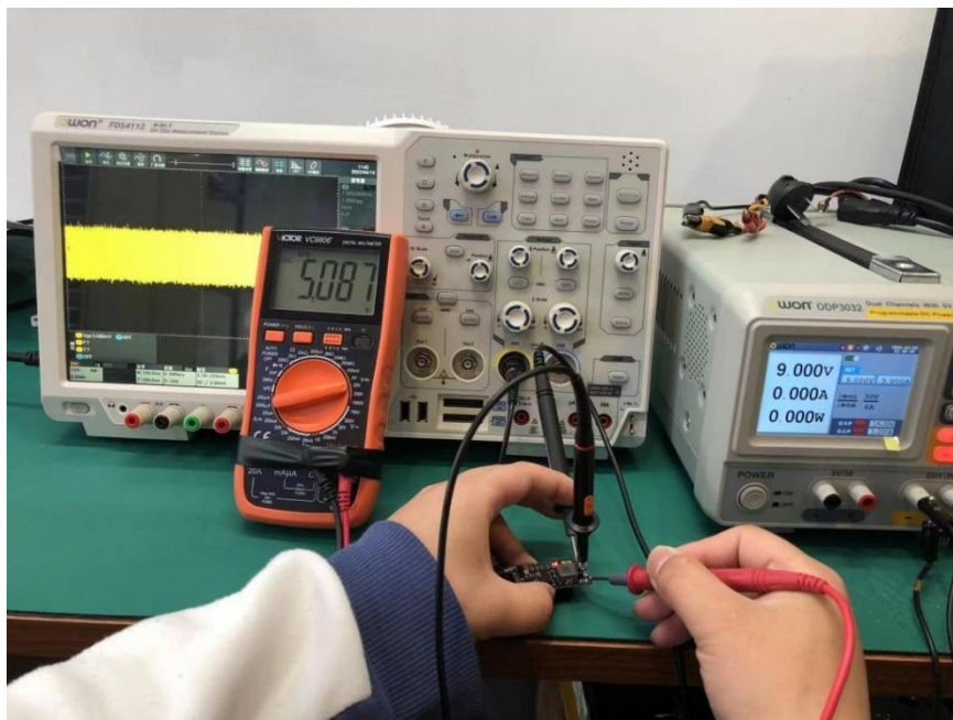
图 4.2.3 输入 9V, 输出 5V (空载)
