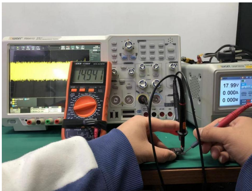
图 4.2.9 输入 18V, 输出 15V (空载)
