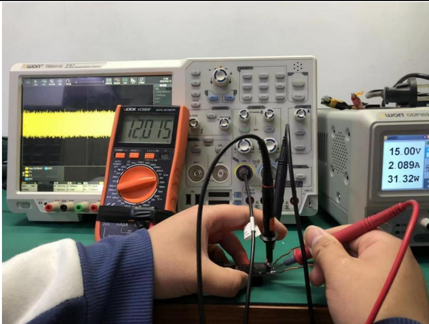
图 4.2.8 输入 15V, 输出 12V (带载)
