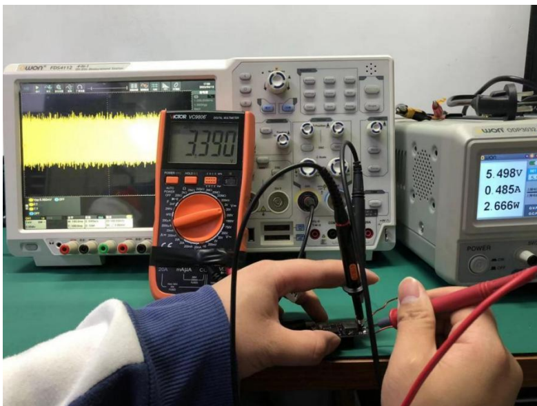
图 4.2.2 输入 5.5V, 输出 3.3V (带载)
