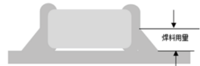
C.使用烙铁返修时的最佳焊料量
