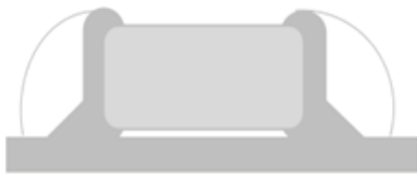
A.焊料过多这样会因电容端头压力过大而可能引起电容受损；
