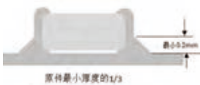
A.回流焊接的最佳焊料用量
