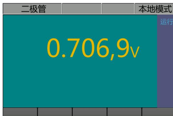
说明：当电压值高于测量门限时显示 OPEN，否则显示测得电压值。
