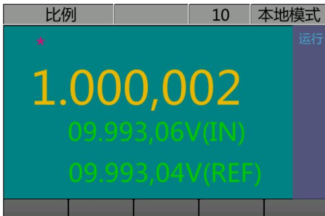
说明：主显表示主输入端和感应端的电压比值，下面（IN）表示的是主输入端测得电压值，（REF）表示感应端测得参考电压值。
