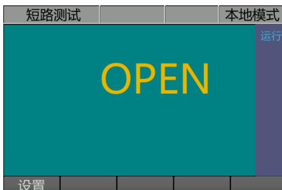
说明：当测得电阻值大于蜂鸣器门限时显示 OPEN，测得电阻值小于蜂鸣器门限时显示电阻值。
