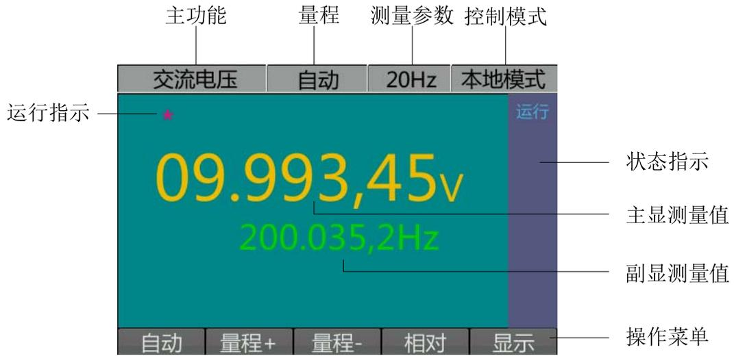
说明：本图是交流电压测量时的界面显示，主显是电压测量值，副显为频率测量值。
