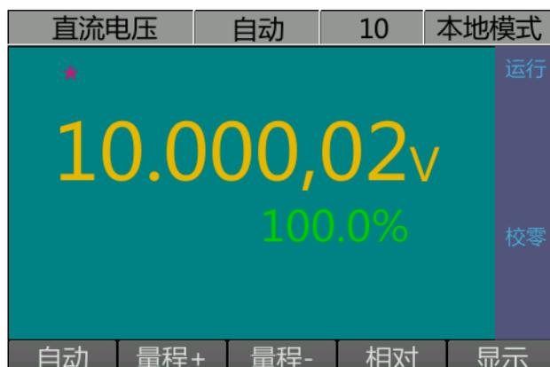
说明：主显值为测量电压值，副显值表示当前测量值与满量程的比值。
