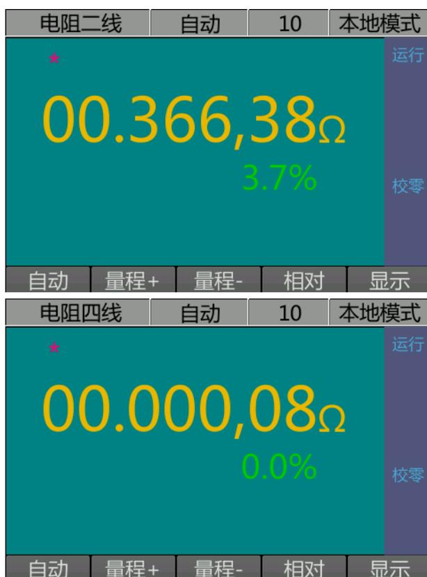
说明：主显值为测量电压值，副显值表示当前测量值与满量程的比值。
