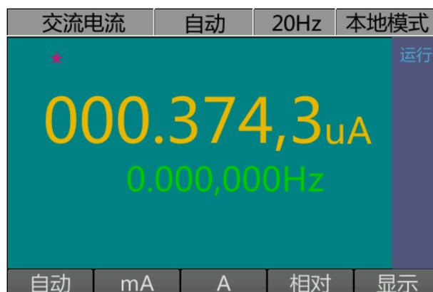
说明：主显值为测量电流值，副显值表示当前输入信号的频率测量值。
