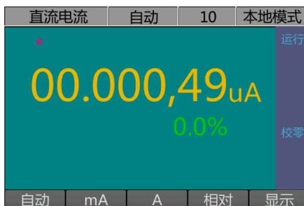
说明：主显值为测量电流值，副显值表示当前测量值与满量程的比值。
