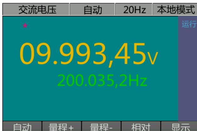
说明：主显值为测量电压值，副显值表示当前输入信号的频率测量值。
