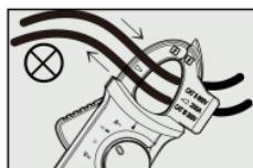
提示：钳头只能夹住单线测量，无法测量两条以上的线
