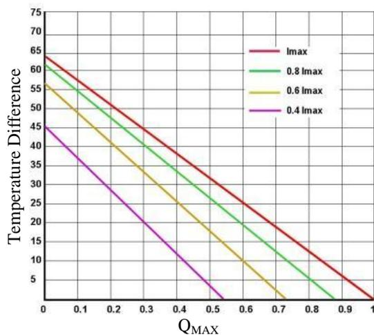
图 2. DT 与 Q<sub>MAX</sub> 的关系图
