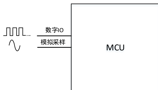
图2-7. 模拟与数字I/O串扰结构图
