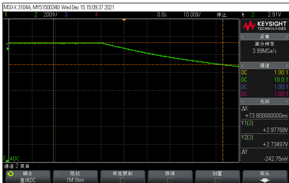
图2-6. 采样间隔时间不足实际参考图
