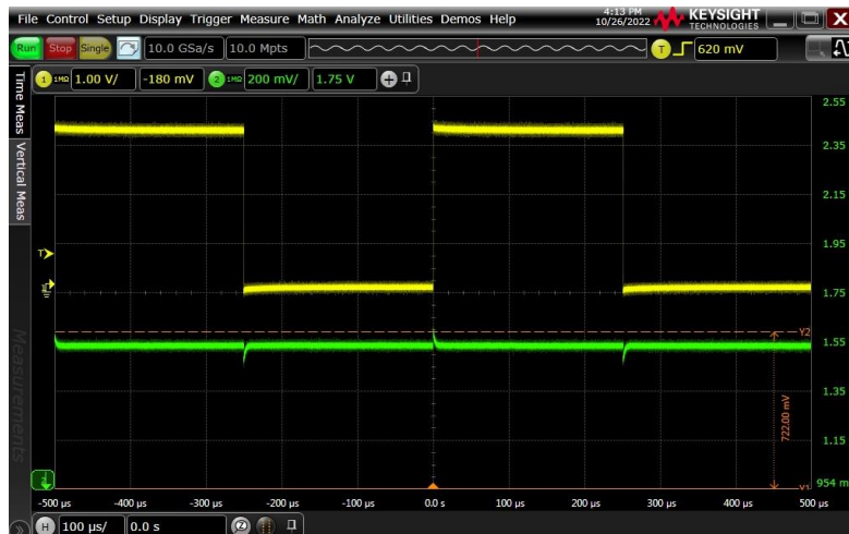
图2-8. 模拟与数字I/O串扰波形图
