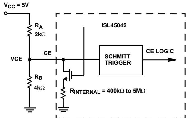
FIGURE 7. APPLICATION GENERATING V<sub>DD</sub> AND V<sub>CE</sub> VOLTAGES
