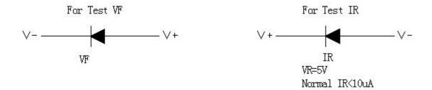
8.6.3 顺向电压 VF 过高或反向电压 VR 过高,均会损坏 LED.
