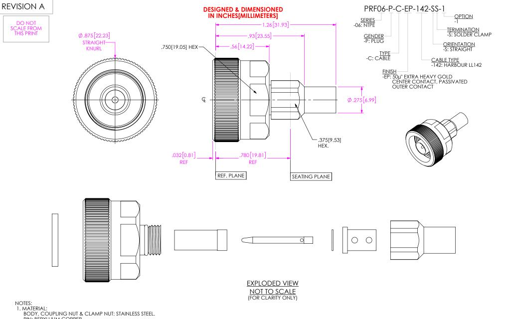
PIN: BERYLLIUM COPPER. SOLDER FERRULE: BRASS. GASKET & O-RING: SILICONE RUBBER. INSULATOR & CABLE STOP: PTFE.
